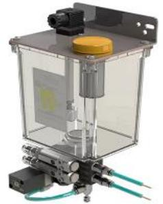
La micro-pompa pneumatica dosa una piccolissima quantità di lubrificante che, attraverso il tubo capillare interno della tubazione coassiale, arriva all'ugello. Il lubrificante viene prelevato dall'aria compressa, che lo polverizza e lo proietta verso il punto di contatto, formando un rivestimento sottile antiaderente.
