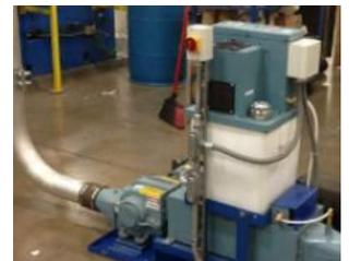
Le aziende che dispongono di più prese che gestiscono scarti di rifili e matrici PSA possono scegliere di utilizzare sistemi di nebbia d'olio individuali oppure, optare per un sistema di lubrificazione a nebbia d'olio centralizzato, che rifornisce tutti i punti di nebulizzazione da un unico contenitore.
